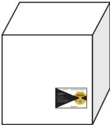
2. 如果包装的长度是包装宽度的两倍，则需要使用两个 ShockDot 防震动指示器。将第二个指示器放置在包装的另一侧的相同位置。
