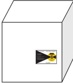
2. 如果包装的长度是包装宽度的两倍，则需要使用两个 ShockDot 防震指示器。将第二个指示器放置在包装的另一侧的相同位置。
