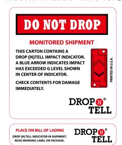
美国生产商制造的 Drop N Tell 产品,中文名为防震贴标签(以下简称),别名为震动标贴、震动显示贴、震动感知器、防震动显示器等。
