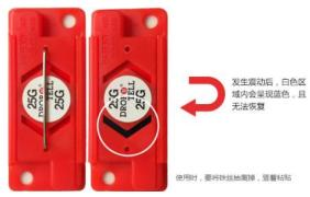
张贴时请按图所示竖着贴,中间铁丝条起保护作用。使用时 应拿掉铁丝条,铁丝条拿开则处于触发状态,发生震动即会 变成蓝色
